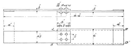
FIG. 16A. LAP JOINT WITH STRAIGHT PLATES,
